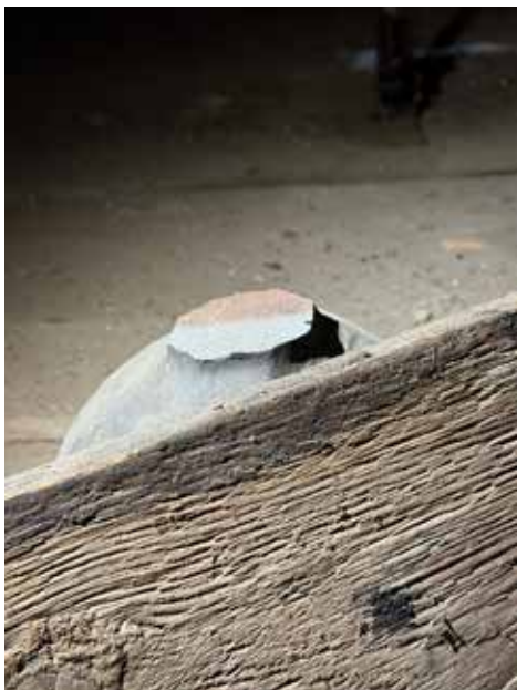
La rucla dil battagl culla crena da ruina (sen.). La fin dil battagl da ca. 100 kg (dretg)
